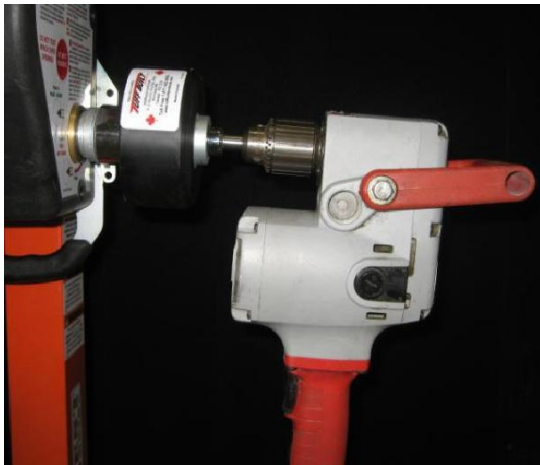
Obrázek 10, Pohon s bezpečnostní spojkou proti přetížení
